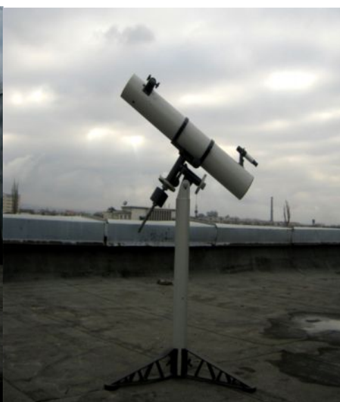
4-сүрөт. Телескоп-рефлектор-ТАЛ-1, D=150\text{мм} ; F = 1200\text{мм} , \Gamma=120 .
